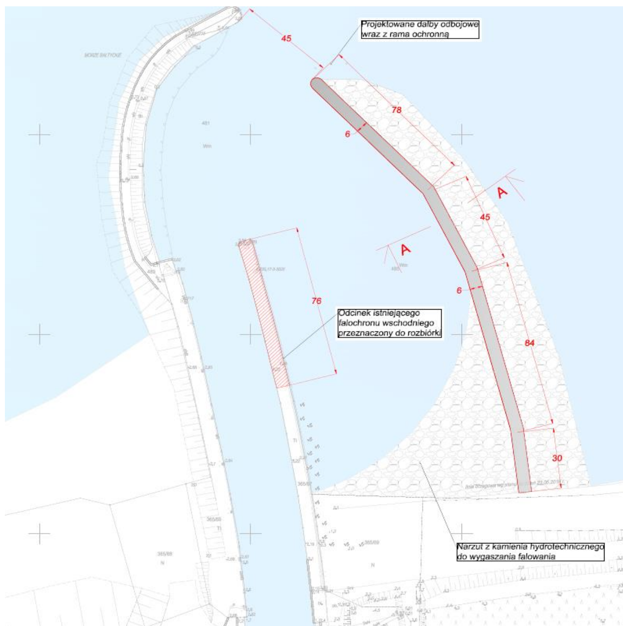
Rysunek 25. Przebudowa falochronu (port Łeba) (źródło: UM Łeba)
