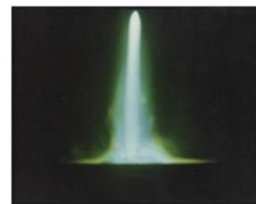
Rys. 14. Model KC-50 z próbką prochu, towobu oraz centralnie położoną rurą z lanym trotylem.
